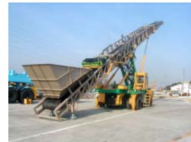
TB5 (油圧折畳式ベルトコンベア 長さ35m) 新日鉄・大分製鉄所 (2002年)
